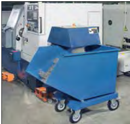
Anwendungsbeispiele: Muldenkipper als Spänebehälter
