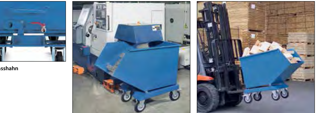
Anwendungsbeispiele: Muldenkipper als Spänebehälter
