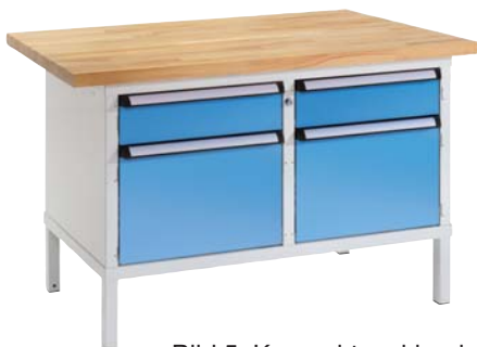
Bild 5, Kompaktwerkbank Basic A64-740-000 à Fr. 761.- extra Unterteilungs-Set F B1500xT700xH840mm 2 Schubladen FH150, 2 Türen H350mm
